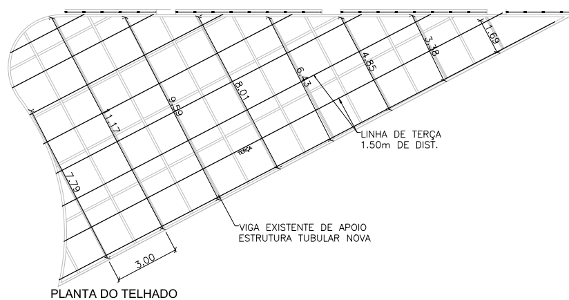
PLANTA DO TELHADO
